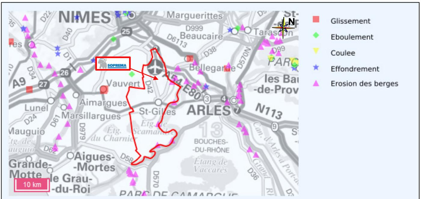
Figure 53 : carte des mouvements de terrain et cavités
